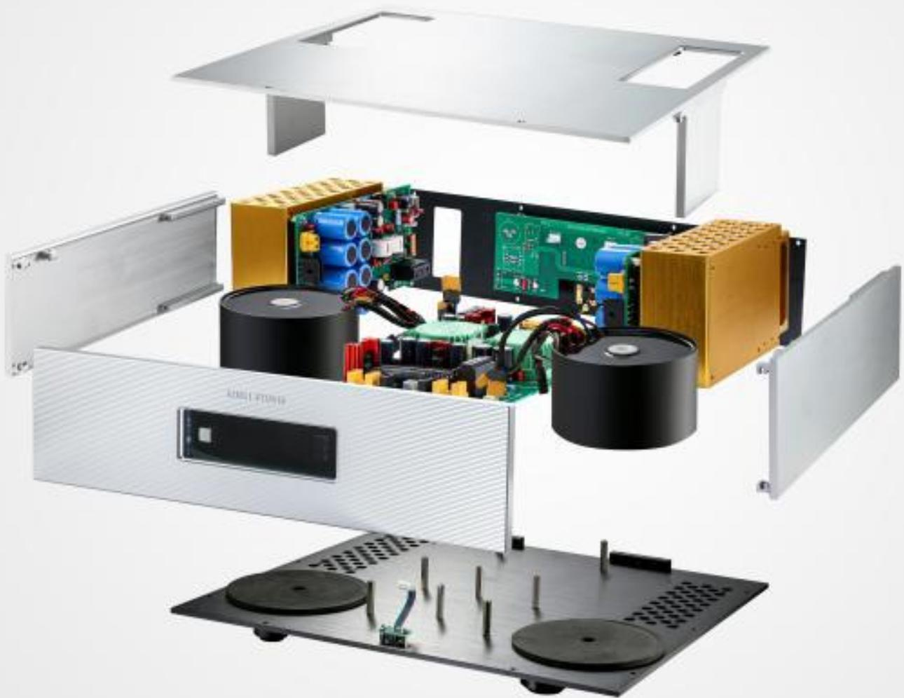
Les dissipateurs anodisés perforés à la façon d'un gruyère garantissent un parfait refroidissement grâce à la circulation de l'air ambiant, sans avoir recours à un ventilateur. C'est assez astucieux. Les circuits imprimés sont également de qualité avec un placage or de 0.2µm.
